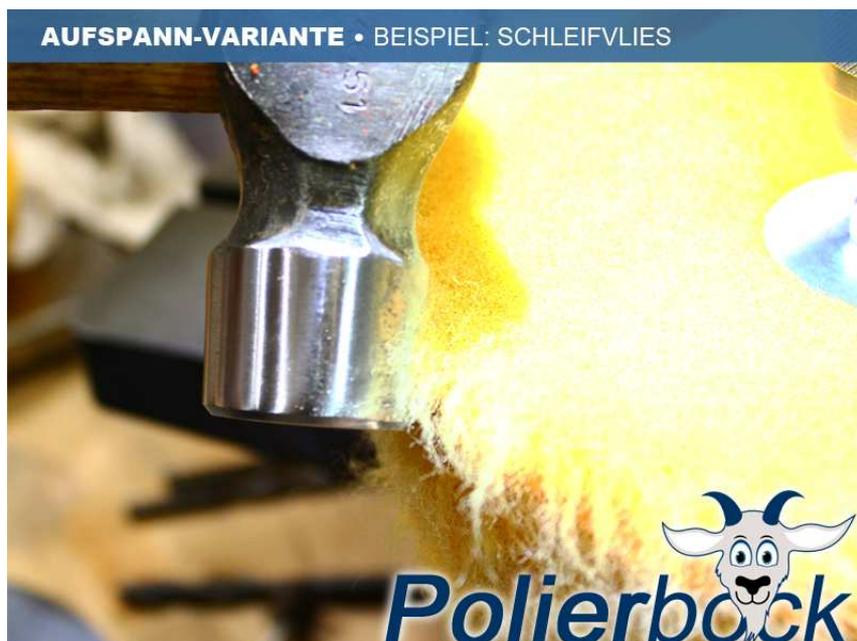
Und hier ist der Stahl-Hammer zu sehen nach der Polietur mit Schleifvlies - bei 3.000U/min.
